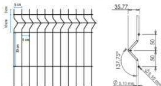
De acordo com o projeto padrão fornecido pelo FNDE (para terreno de 40 x 60 m), haverá fechamento com gradil de 1,58m de altura, com pilaretes metálicos e tela de aço galvanizado de tamanho fixo, instalado na parte frontal do lote, acima de mureta de alvenaria de 0,62m de altura. Caso o terreno disponível seja maior, o ente requerente poderá utilizar-se do padrão de fechamento aqui descrito para a instalação em todo o seu terreno, ficando o custeio do excedente a cargo do requerente.
